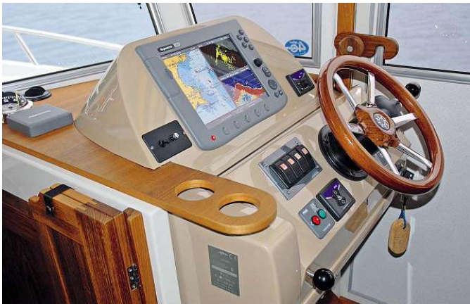
Приборная доска вместе со штурвалом может быть установлена в горизонтальное положение.
