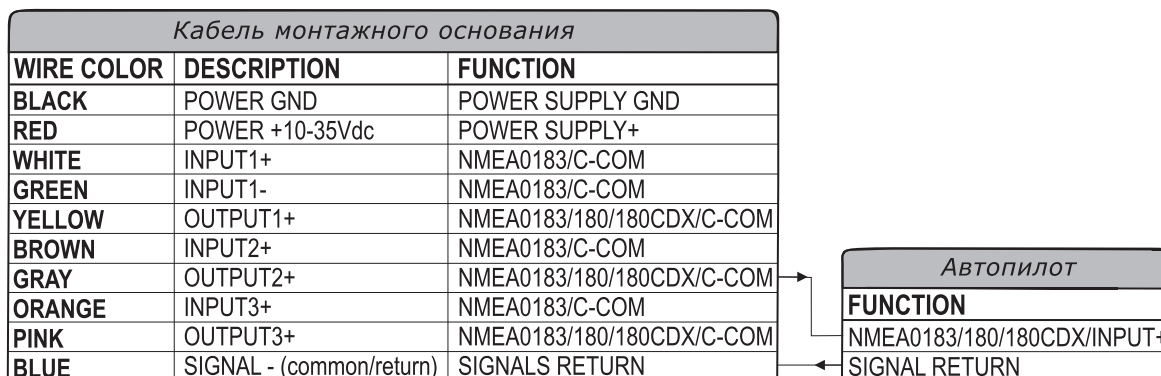
Подключение автопилота к порту 2
