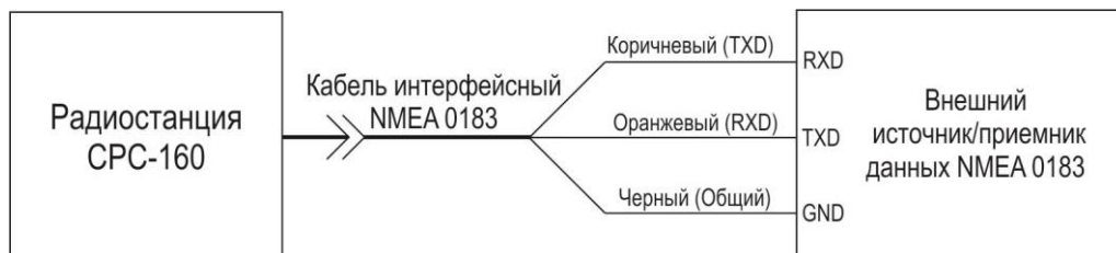
Рисунок А.9 – Схема подключения внешнего источника/приемника данных NMEA 0183
