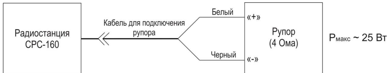
Рисунок А.8 – Схема подключения рупора с сопротивлением катушки 4 Ома
