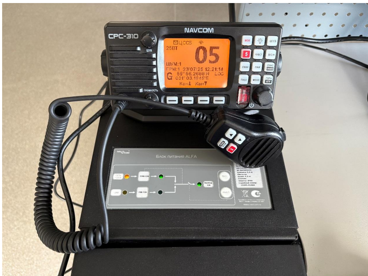
Фото 4 – УКВ-радиотелефонная станция NavCom CPC-310 с блоком питания NavCom Alfa 2
