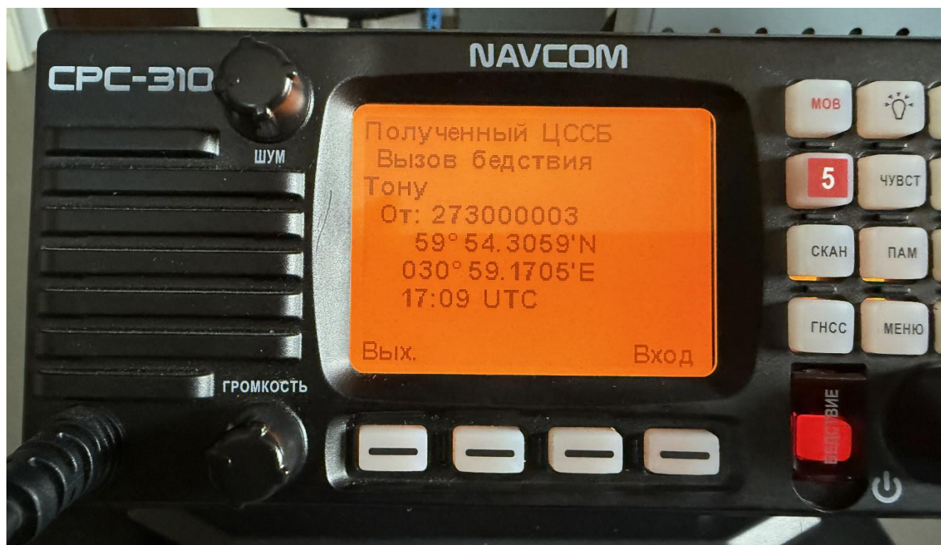
Фото 13 – Экран радиостанции с условным названием «BEREG» после получения сигнала о бедствии с категорией «Потопление» от радиостанции с условным названием «SUDNO 2»
