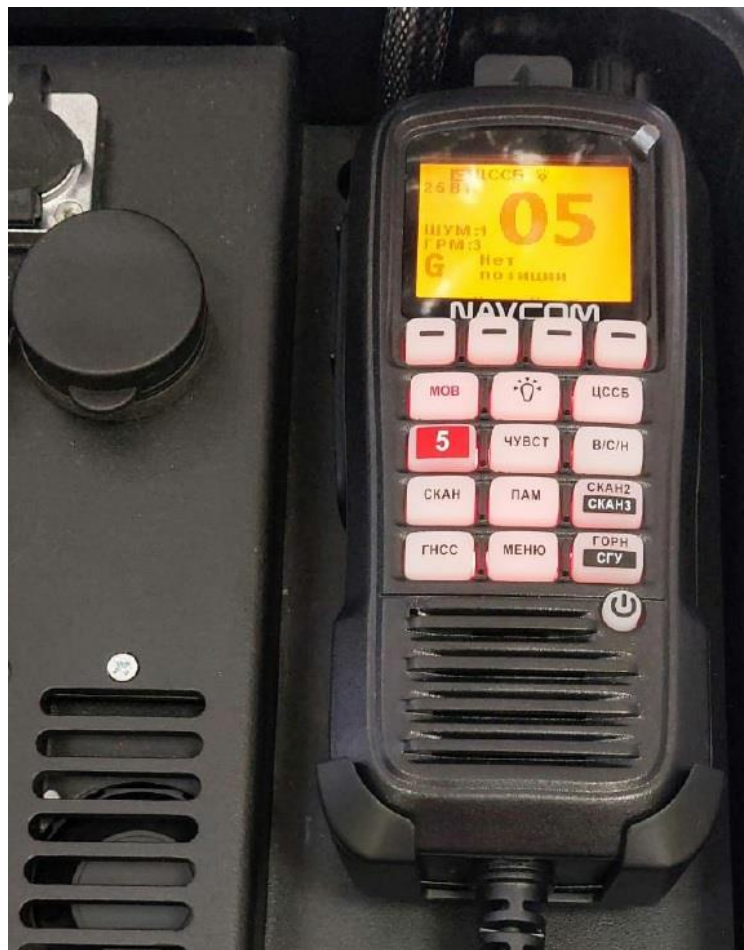
Фото 5 – УКВ-радиотелефонная станция NavCom CPC-311 (установлена в защитном кейсе)
