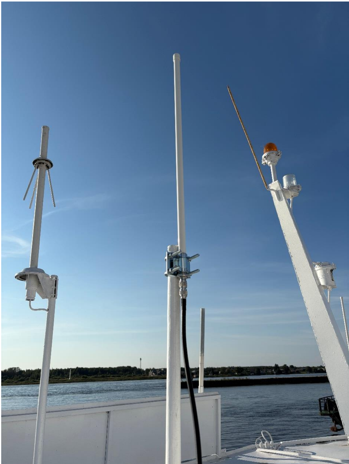
Фото 7 – УКВ антенна NavCom АИС-700Р
