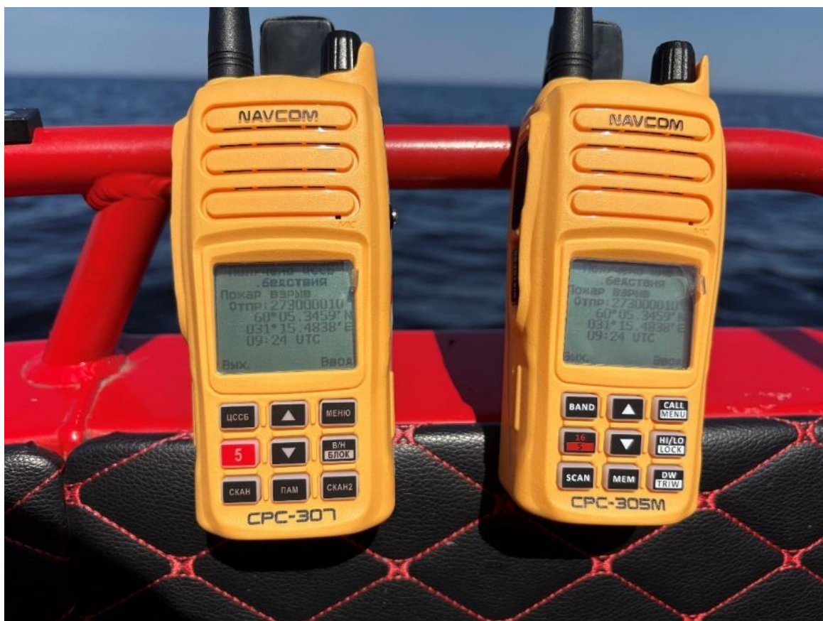
Фото 6 – УКВ-радиотелефонные станции NavCom CPC-305M и CPC-307
