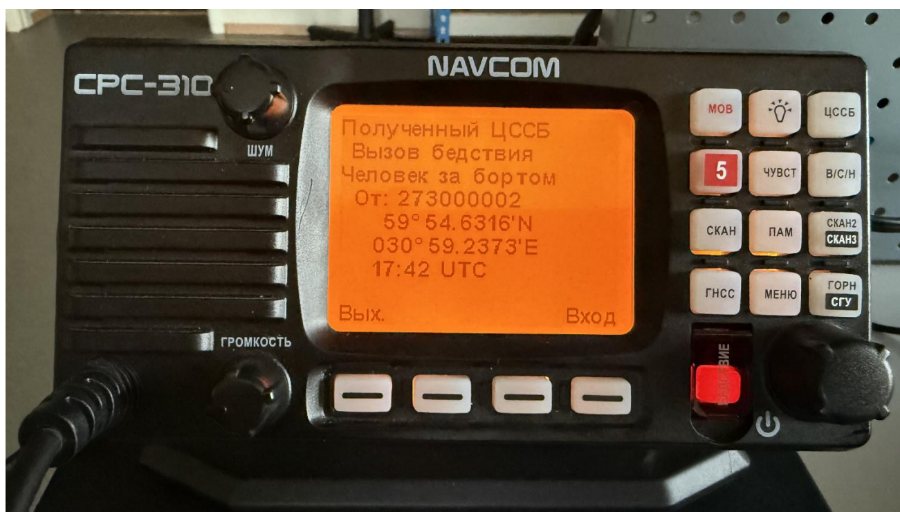
Фото 15 – Экран радиостанции с условным названием «BEREG» после получения сигнала о бедствии с категорией «Человек за бортом» от радиостанции с условным названием «SUDNO 1»
