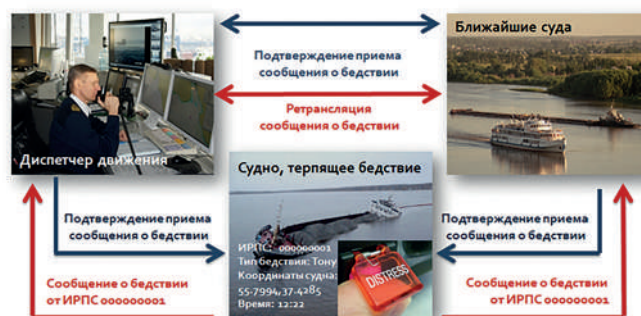
Рисунок 1 Принцип работы ЦССБ
