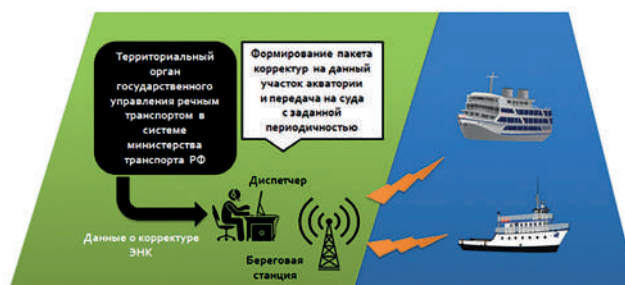
Рисунок 4 Передача корректуры электронных навигационных карт
