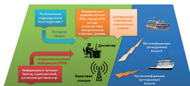
Рисунок 3 Передача метеорологической и путевой информации
