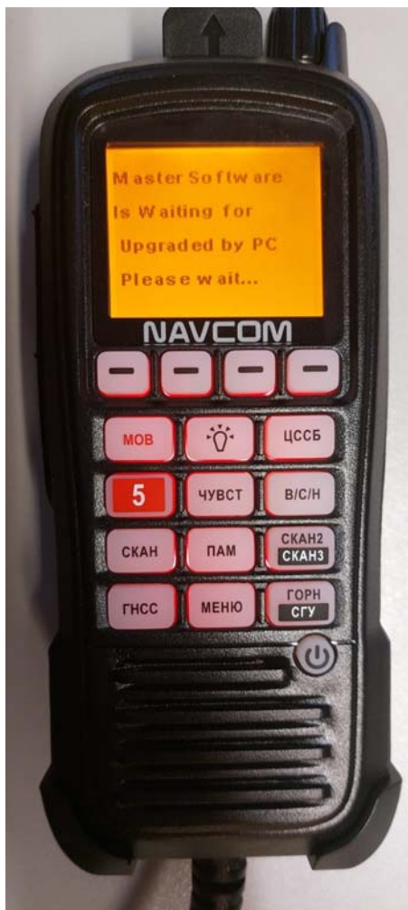
Рисунок 2 – Экран тангенты МТТ-1 в режиме обновления прошивки
