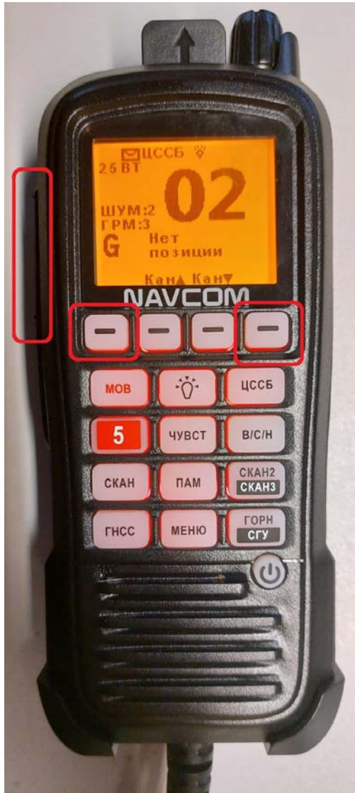
Рисунок 10 – Вход в режим обновления прошивки
