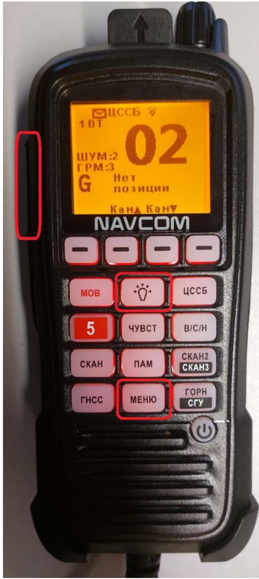
Рисунок 1 – Вход в режим загрузки прошивки
