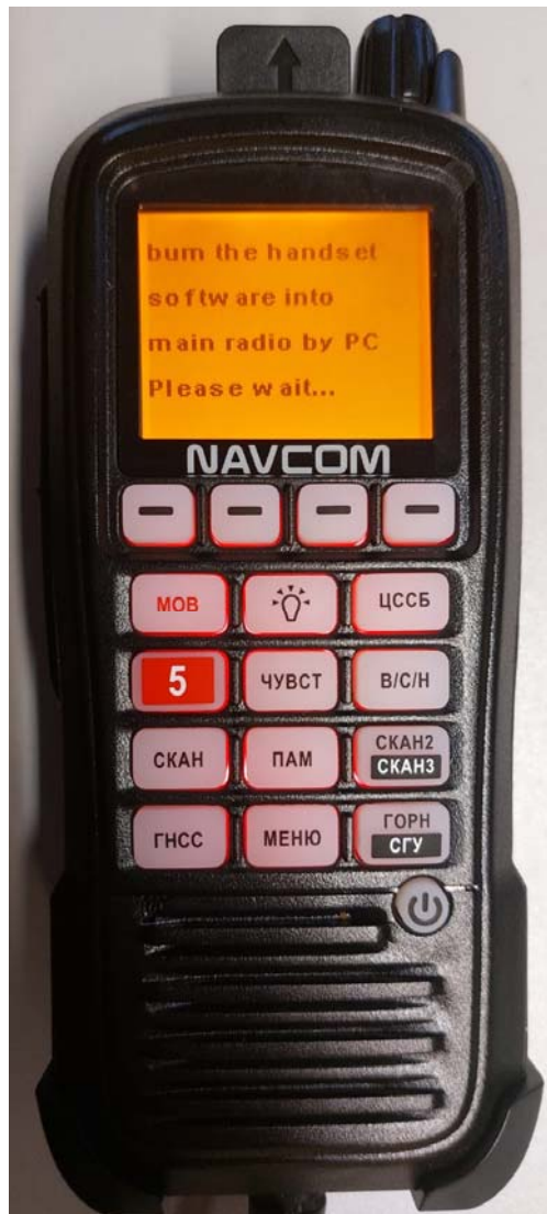
Рисунок 2 – Экран тангенты в режиме загрузки прошивки
