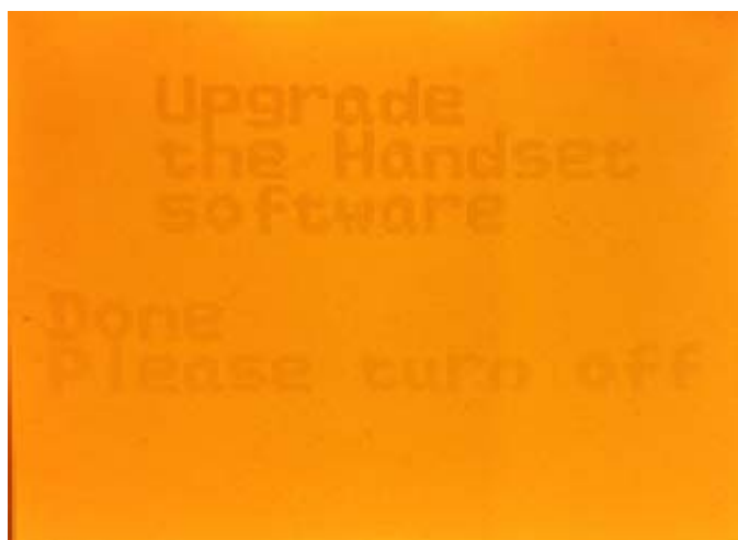
Рисунок 12 – Экран тангенты после завершения обновления прошивки
